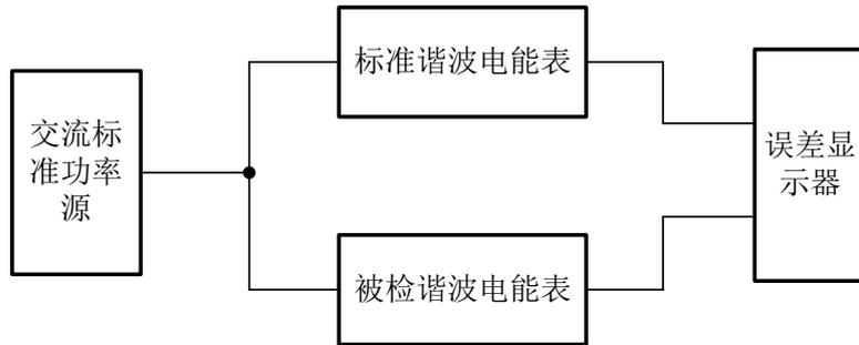
图A.1 谐波条件下的准确度试验接线图
